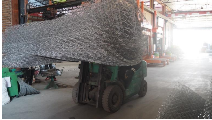
ภาพ 4.7 การใช้รถโฟล์คลิฟท์ในการขนย้ายลวดถักไปทำการพันขอบ
